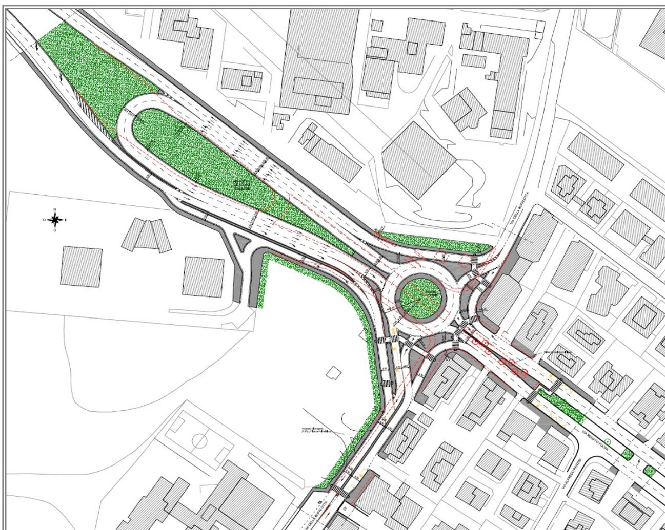
Le caratteristiche geometriche della rotatoria prevedono un raggio esterno di 24,5 metri, un anello di due corsie larghe 4 metri per un totale di 8 metri, ed una banchina interna sormontabile larga 3 metri. Sono previste inoltre, quattro corsie di manovra esterne alla rotatoria dedicate ai movimenti di svolta a destra. La rotatoria prevede in realtà solo tre entrate facendo sì che non sia possibile immettersi in anello provenendo da via della
